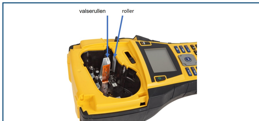
Afbeelding 39 • Printkop en drukrol in cassetterek
